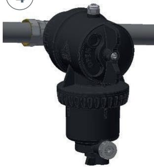
Aprire lo scarico e svuotare l'acqua contenuta all'interno. Utilizzare recipiente di raccolta di almeno 1 l.
