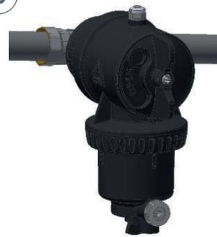
Chiudere lo scarico. Rimontare il tappo grigio di sicurezza. Rimontare il magnete. Girare la manopola su open. Azionare la pompa.
