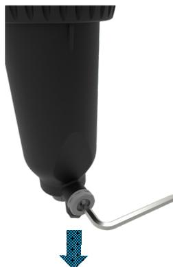
Aprire valvola di scarico per depressurizzare impianto (5 secondi) e richiudere. Utilizzare un recipiente per raccogliere acqua in scarico.
