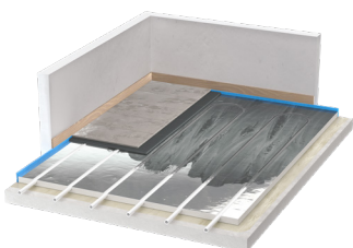
Posa rivestimento ceramico
