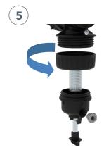
Dévisser la bague. Relâcher le corps. Retirer l'aimant (le ranger dans un endroit propre). Retirer la cartouche en acier inoxydable. Laver le corps et la cartouche sous l'eau courante.
