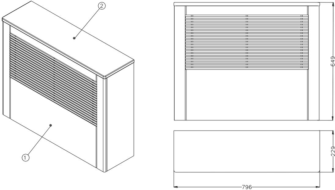
Il mobiletto va fissato alla parete, ad una altezza consigliata di 15-20 cm dal pavimento. Per il fissaggio vanno utilizzati i fori  $\varnothing=5$  mm presenti sulle quattro squadrette metalliche all'interno della cornice.
