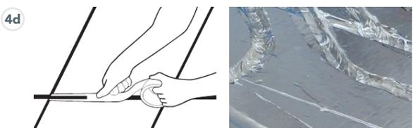
Nonostante i pannelli **KILMA FUTURA** siano già dotati di gole e curve preformate per l'alloggiamento delle tubazioni potrebbe essere necessario tagliare in loco una nuova traccia e per creare un circuito completo, soprattutto dove i tubi vengono uniti per congiungersi al collettore, o per realizzare particolari curve o percorsi non pre-tracciati sul pannello.
