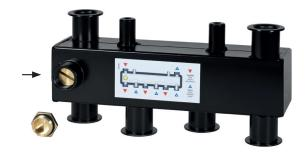
RBM MULTIMIX DN25 è dotato di un innovativo sistema che consente, attraverso l'intervento manuale su di un otturatore filettato, di ottenere la separazione o l'unione della camera di mandata con quella di ritorno trasformando di fatto il collettore/ separatore in un semplice collettore e viceversa.
