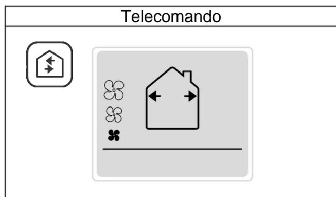
Premendo il relativo tasto tutte le unità funzioneranno costantemente in espulsione con la possibilità di cambiare la velocità di funzionamento in base alle proprie esigenze.
