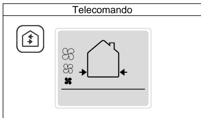
Premendo il relativo tasto tutte le unità funzioneranno costantemente in immissione con la possibilità di cambiare la velocità di funzionamento in base alle proprie esigenze.
