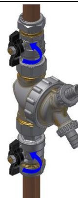
4 - Raccordez les tuyaux aux deux raccords de tuyau du connecteur, ouvrez les vannes à bille, mettez le système en marche et effectuez le rinçage.
