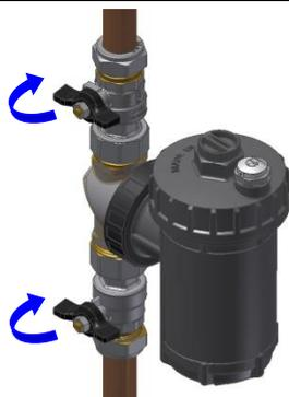
1 - Isoler le filtre en fermant les vannes à bille.
