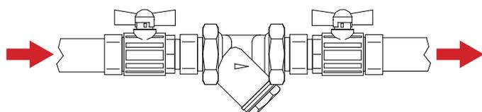
Il filtro deve essere installato in posizione orizzontale con la sede porta-filtro rivolta verso il basso. Il filtro deve essere inserito all'interno del circuito rispettando la freccia direzionale stampata sul filtro che indica la direzione di flusso del circuito.
